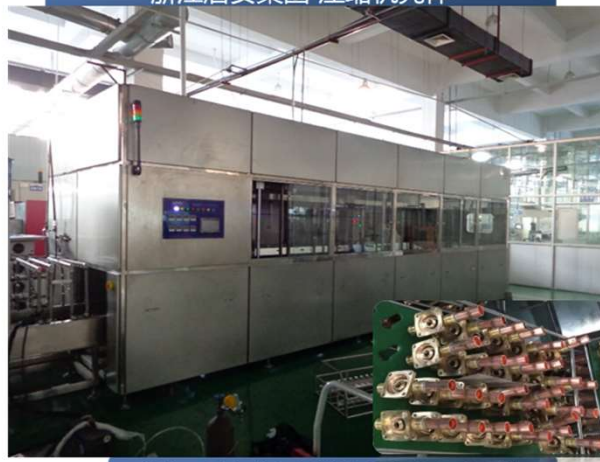
浙江盾安集团-膨胀阀钎焊后清洗
