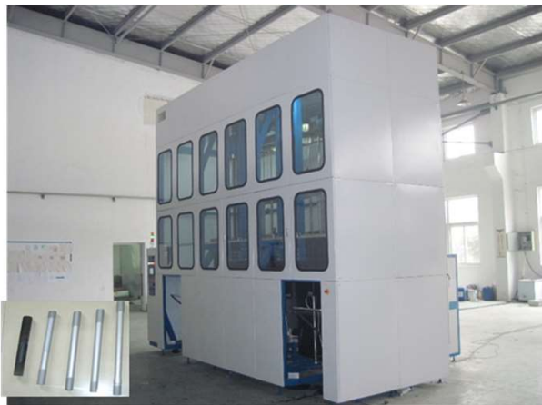
上海达克罗 - 风电螺栓达克罗涂覆前清洗
