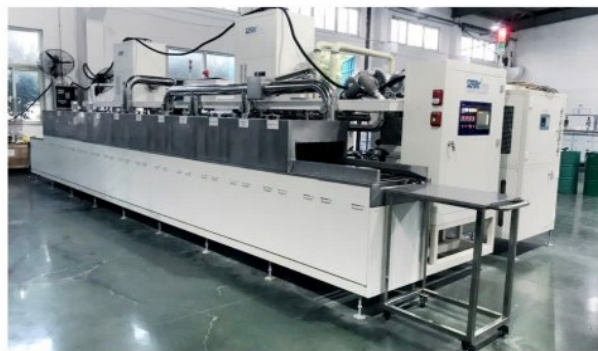
设备名称: FWA-932TRQ 通过式自动超声波喷淋清洗机 清洗对象:汽车电机轴最终清洗 清洗流程:上料→喷淋清洗→移动切油→喷淋清洗→移动切油→喷淋清洗→移动切油→喷淋防锈→移动切油→热风烘干→下料(清洗介质:碳氢) 典型用户:格林精密部件(苏州)有限公司
