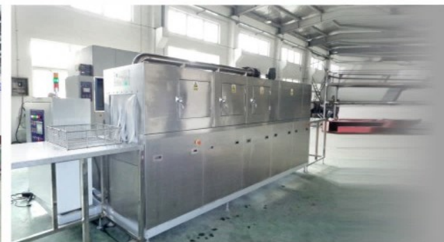
设备名称: FWA-4000TPZ 通过式喷淋清洗机 清洗对象:减震部件的清洗、干燥 清洗流程:喷淋脱脂清洗→喷淋漂洗→喷淋漂洗→热风烘干(清洗介质:水基) 典型用户:康迪泰克(中国)橡塑技术有限公司(2台) 哈金森工业橡胶制品(苏州)有限公司
