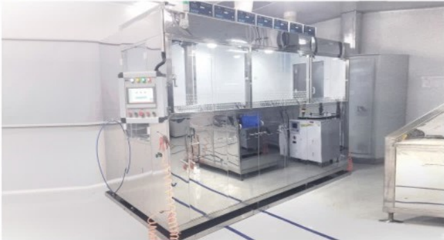
设备名称:FWA-6120TYM全自动超声波清洗机 清洗对象:外科手术器械部件 清洗流程:上料→超声波+喷流→超声波清洗+喷流→浸泡漂洗+喷流→喷淋漂洗→高压风切→热风烘干→下料 典型用户:天臣国际医疗科技
