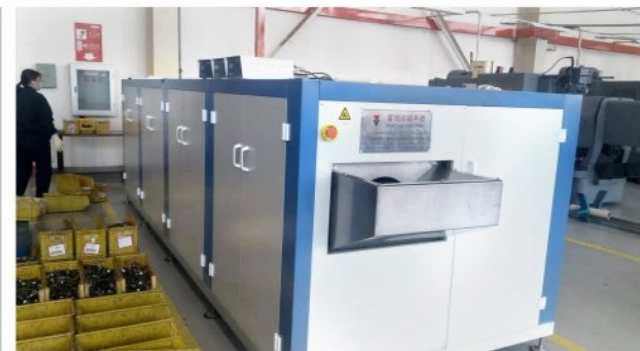
设备名称: FWA-3320TVB 涡旋式超声波喷淋清洗机 清洗对象:液压胶管接头的清洗、干燥 清洗流程:自动上料→超声波清洗→喷淋清洗→切水→烘干→下料(清洗介质:水基) 典型用户:莱科液压设备(大连)有限公司
