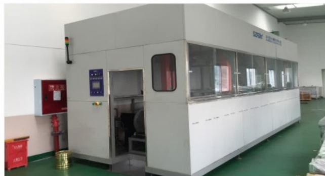
设备名称: FWA-5120MDGT 自动滚篮式超声波清洗机 清洗对象:刹车片背板涂覆前清洗、干燥 清洗流程:上料→超声波粗洗→超声波精洗→超声波漂洗→热浸泡漂洗→热风干燥→下料(清洗介质:水基) 典型用户:相信制动系统(无锡)有限公司 四川相信制动系统有限公司
