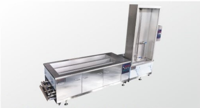
设备名称:FWA-4096TG 四槽式超声波清洗机 清洗对象:医用金属导管 清洗流程:超声波清洗→超声波漂洗→纯水漂洗→冲淋漂洗 典型用户:上海微创医疗器械集团 江苏众鑫磊电子材料有限公司
