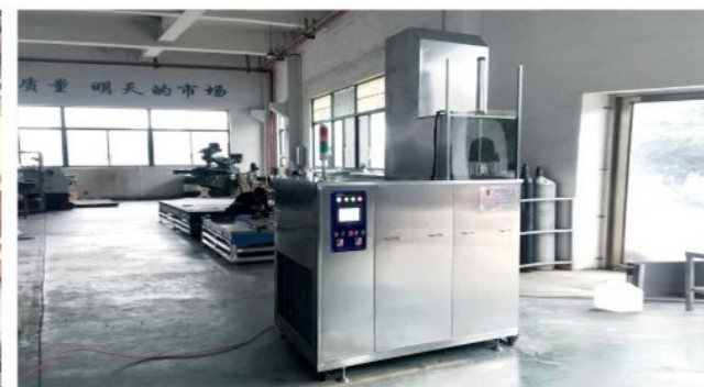
设备名称: FRA-3036TSGQ 垂直式气相清洗机 清洗对象:汽车空调部件脱脂清洗 清洗流程:超声波清洗→蒸气浴洗→冷冻干燥 典型用户:北京海松元汽车部件有限公司 苏州世翔点火器有限公司
