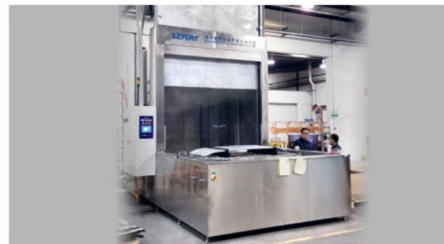
设备名称: FWP-3000PTZ 旋转式自动高压喷淋清洗机 清洗对象:汽车防撞梁、保险杠喷涂前的清洗、干燥 清洗流程:吊装上料→自动进料→脱脂高压喷淋清洗→压缩空气切水→防锈中压喷淋漂洗→压缩空气切水→自动出料(清洗介质:水基) 典型用户:顺普汽车零部件(中国)有限公司
