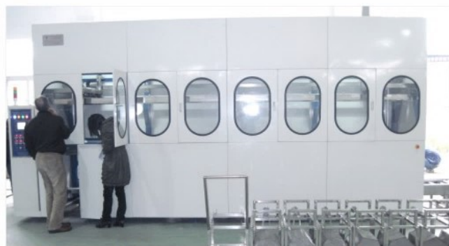
设备名称: FWA-8096FAK 自动滚篮式超声波清洗机 清洗对象:ABS器件装配前最终清洗、干燥 清洗流程:上料→超声波粗洗→超声波精洗→超声波漂洗→钝化→超声波漂洗1→超声波漂洗2→热浸泡漂洗→热风干燥→下料(清洗介质:水基) 典型用户:德尔福(上海)动力推进系统有限公司 京西重工(上海)有限公司
