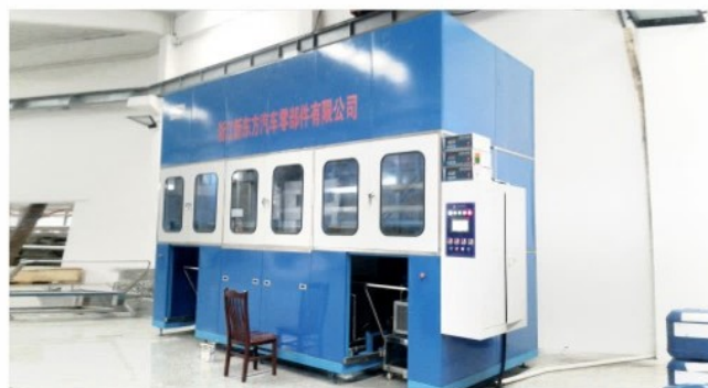
设备名称: FWR-5150FAK 自动滚篮式超声波清洗机 清洗对象:汽车用紧固件涂覆前清洗、干燥 清洗流程:上料→超声波粗洗→超声波精洗→超声波漂洗→蒸汽浴洗→冷冻干燥→下料(清洗介质:环保型有机溶剂) 典型用户:浙江新东方汽车零部件有限公司
