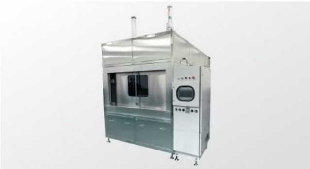
设备名称:FWP-2180PST旋转喷淋清洗机 清洗对象:香精容器清洗干燥 清洗流程:上料→纯水喷淋冲洗→碱液喷淋清洗→纯水喷淋漂洗→高压风切→热风烘干→下料 典型用户:小川香料(上海)有限公司
