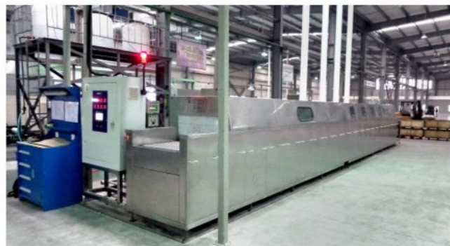
设备名称: FWA-6090TPC通过式超声波喷淋清洗机 清洗对象:汽车发动机法兰轴最终清洗 清洗流程:上料→超声波清洗→喷淋清洗→喷淋漂洗→喷淋防锈→压缩空气切水→热风烘干→下料(清洗介质:水基) 典型用户:万向集团-江苏森威精锻有限公司(3台) 长春市美科汽车零部件有限公司
