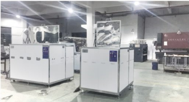
设备名称:FR-3060FJC超声波气相清洗机 清洗对象:内窥镜金属管工序间清洗 清洗流程:超声波清洗→超声波漂洗→蒸汽浴洗→冷冻干燥(环保型有机溶剂) 典型用户:脉通医疗科技(嘉兴)有限公司
