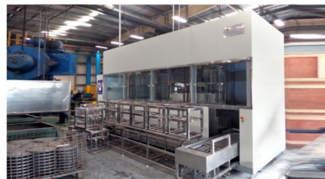
设备名称: FWA-5150EGD 自动回转式超声波清洗机 清洗对象:复合磨擦片的清洗、干燥 清洗流程:超声波清洗→超声波清洗→超声波漂洗→浸泡防锈→热风烘干(清洗介质:水基) 典型用户:霍克复合材料(苏州)有限公司
