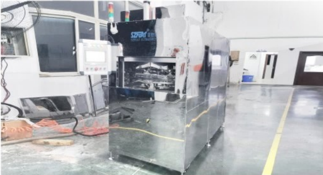
设备名称:FWA-600PTS旋转喷淋清洗机 清洗对象:骨修复材料 清洗流程:上料→纯水喷淋冲洗→纯水喷淋漂洗→高压风切→下料 典型用户:烟台正海生物科技股份有限公司
