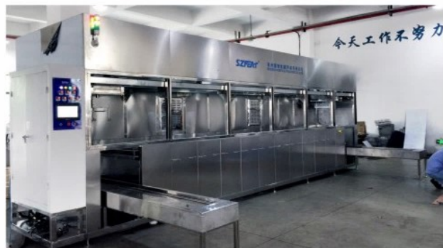
设备名称: FWA-10150TS2G 自动超声波清洗机 清洗对象:变速器零部件精加工后清洗、干燥 清洗流程:上料→超声波粗洗→超声波精洗→超声波漂洗→钝化→超声波漂洗→超声波漂洗→热浸泡漂洗→切水→热风干燥1→热风干燥2→下料(清洗介质:水基) 典型用户:长春市美科汽车零部件有限公司
