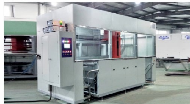
设备名称: FWA-5108TAC 自动超声波清洗机 清洗对象:粉末冶金件(活塞)的清洗、干燥 清洗流程:超声波清洗→超声波清洗→超声波漂洗→浸泡防锈→热风烘干(清洗介质:水基) 典型用户:浙江创能机械股份有限公司(2台)
